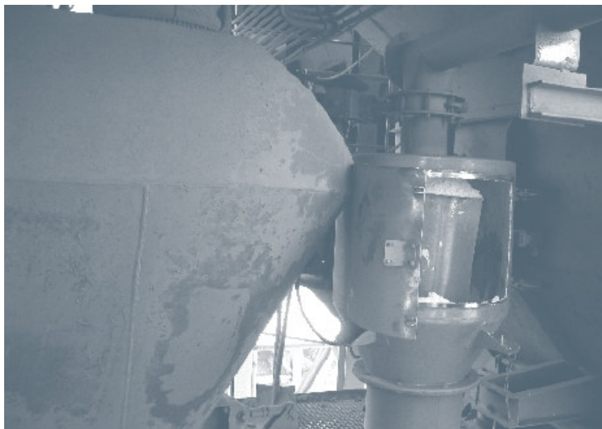
Rysunek 11 – Zasobnik wagowy służący do odmierzania ilości zeolitu
