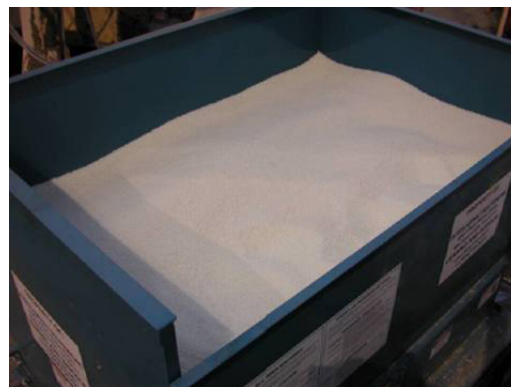
Rysunek 4 – Zasobnik dozatora wypełniony granulkami Sasobitu
