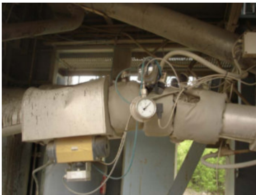
Rysunek 15 – Komora spieniania w powiększeniu
