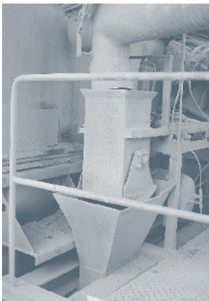
Rysunek 6 – Zasobnik wagowy służący do odmierzania niezbędnej ilości środka – wytwórnia mas bitumicznych w Niemczech
