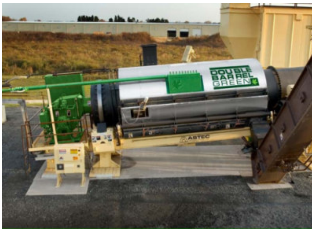
Rysunek 16 – Ogólny widok bębna suszarki wytwórni Astec Double Barrel Green. W centrum widoczny jest zespół dysz do wtryskiwania wody i asfaltu.
