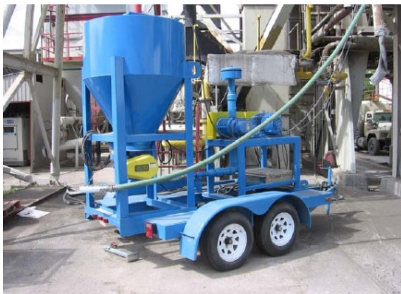
Rysunek 12 – Przewoźny silos zeolitu współpracujący z otaczarnią o działaniu ciągłym
